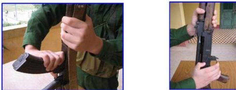
Hình 4-21. Tháo hộp tiếp đạn và kiểm tra súng
