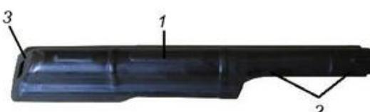
Hình 4-7. Nắp hộp khoá nòng
